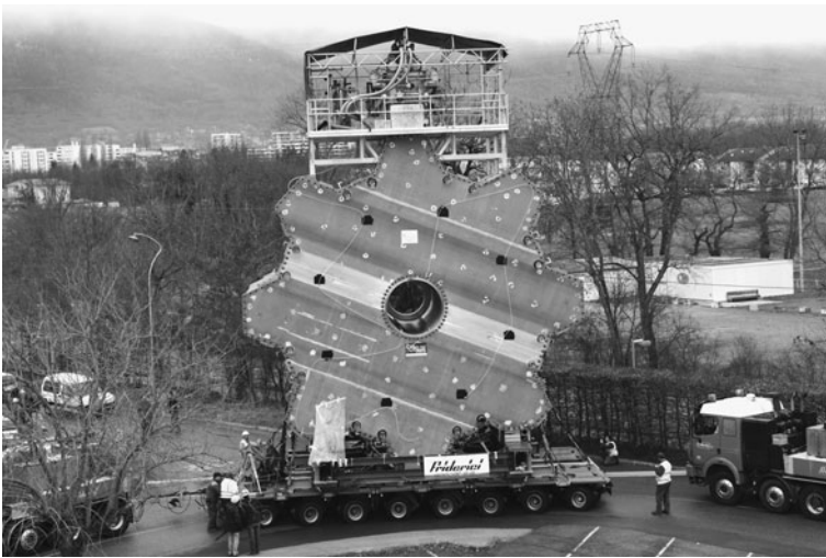
Abb. 6.12 Transport des zweiten 240 Tonnen schweren ATLAS-Endkappen-Toroidmagneten auf einem Schwertransporter mit 128 Rädern; 6. Februar 2007
